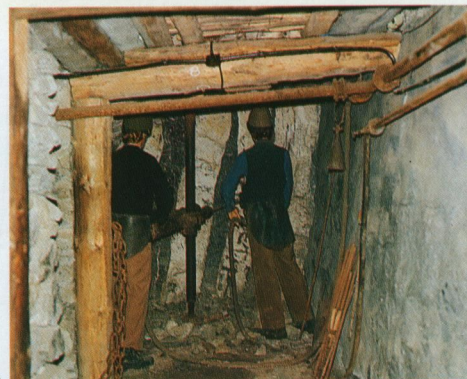
Unter Tage im Schaubergwerk: An der Druckluft-Säulenbohrmaschine
